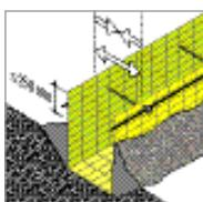
Za izvedbu temelja srednjih dubina uz dodatno osiguravanje sa Pecafil® distancerima razmaka kako bi se izbjeglo savijanje oplate za vrijeme betoniranja.
